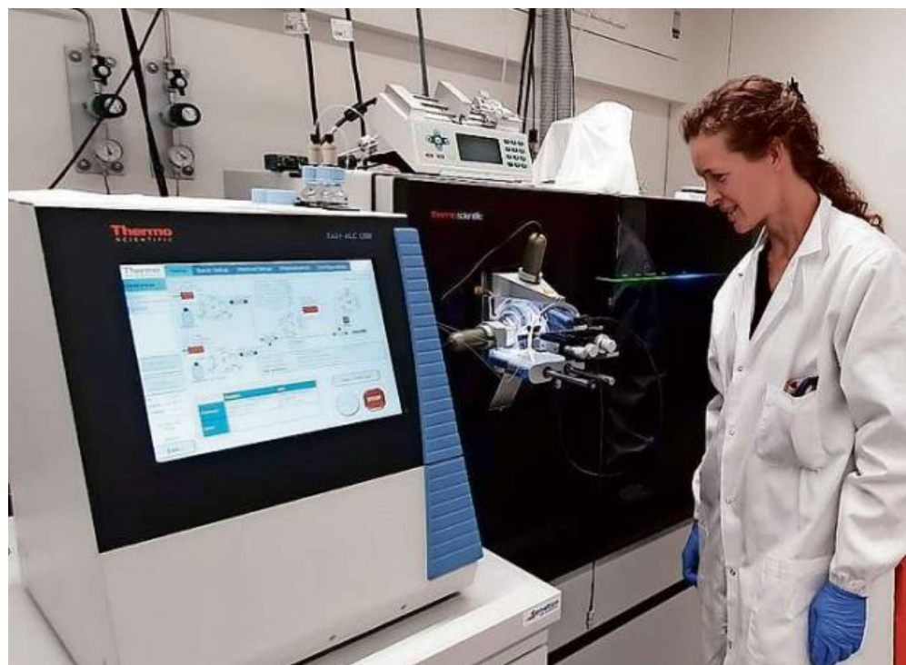
Das Orbitrap Eclipse Massenspektrometer ist das Kernstück des neuen Zentrums für Proteomics.
